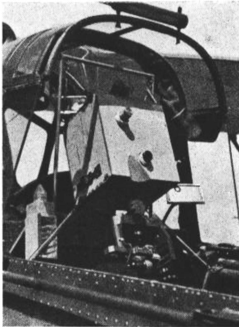
Abb. 16 Mikroskop im Beobachterstand der Nahaufklärermaschine Hs 126
