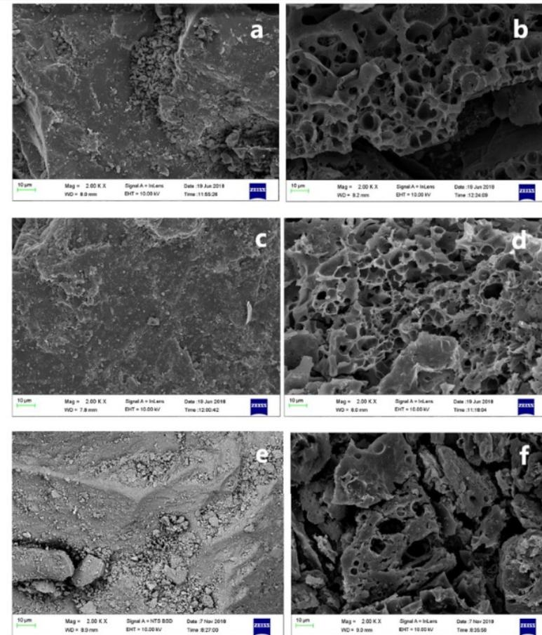
Fig. 4. SEM images of (a) run of mine coal (b) ACR (c) discard coal (d) ACD (e) Slurry coal (f) ACS.
